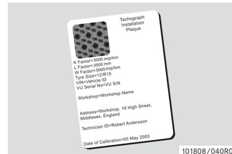
! Durante la inspección la placa de instalación debe ser válida y no estar rota.
