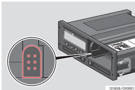
3 Empiece a descargar los datos según las instrucciones del equipo de descarga. Se mostrará el siguiente mensaje, indicando que la descarga del tacógrafo está activa.
